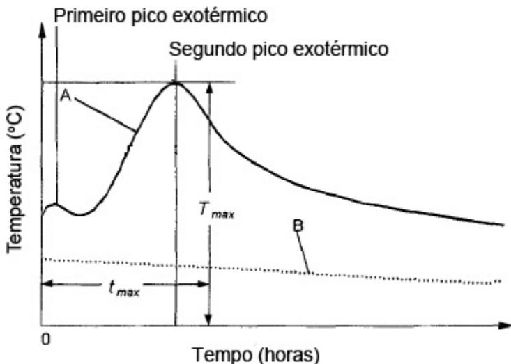
Legenda: Sendo: A, a curva do cimento; B, a temperatura ambiente;  $T_{max}$ , a temperatura máxima de hidratação;  $t_{max}$ , o tempo necessário para atingir a temperatura máxima.
