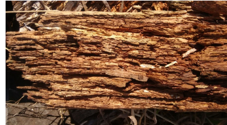
Figura 3.3. Madeira de Eucalyptus sp. atacada por fungo de podridão mole.
