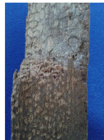
Figura 4.1. Madeira tropical infectada com bolsas de podridão branca na superfície e interior inteiramente atacado.
