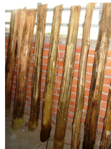
Figura 11.2. Toretas de Eucalyptus grandis preparados para o método de substituição de seiva.
