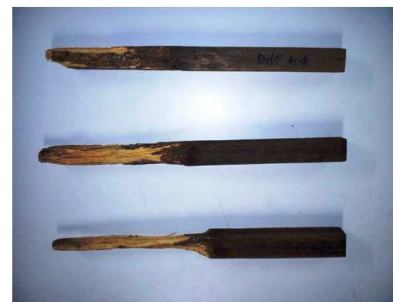
Figura 8.2. Detalhe de madeira de Eucalyptus dunni submetida a campo de apodrecimento após 405 dias.
