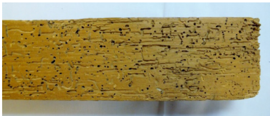
Figura 6.3. Orifícios de saída do besouro Lyctus e o pó fino associado ao ataque. Fonte: Autoria própria (2016)
