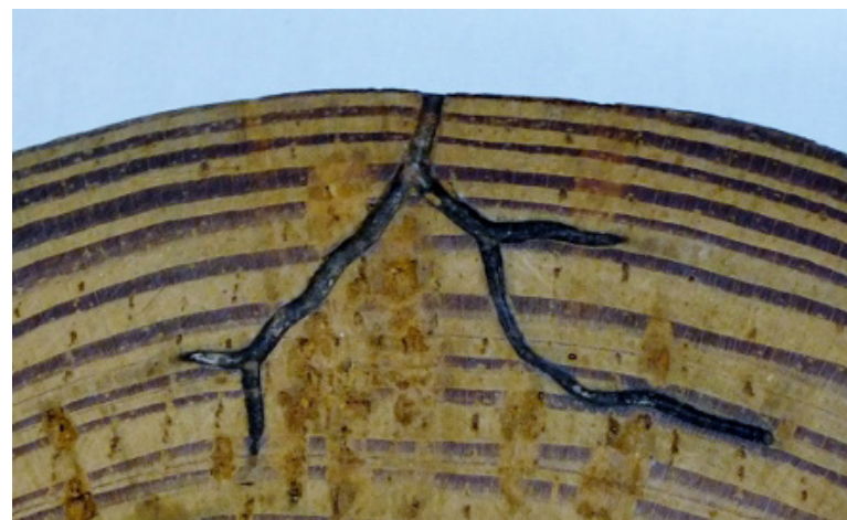
Figura 6.4. Túneis feitos por besouros Ambrósia manchados por fungos. Fonte: Autoria própria (2016)
