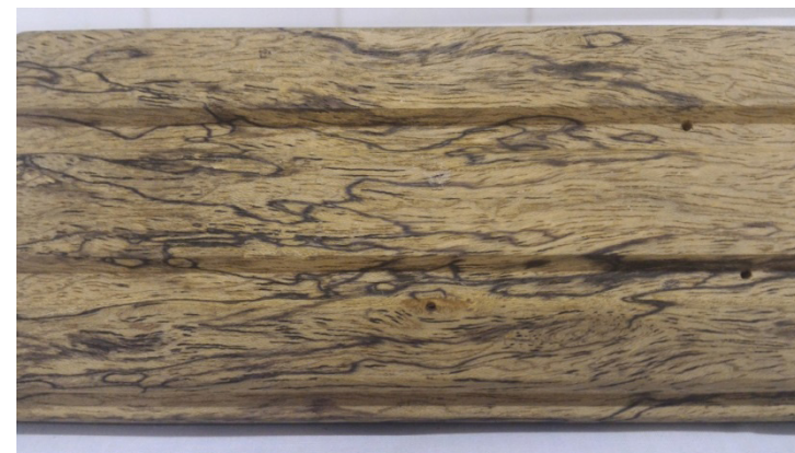
Figura 4.2. Ataque de podridão branca separada da madeira não atacada pela típica linha escura.
