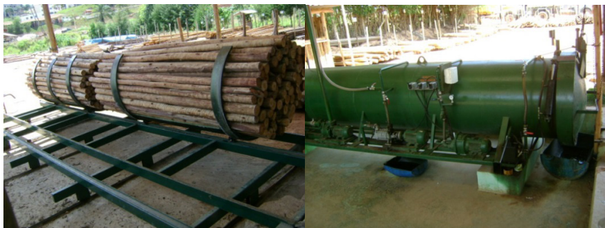
Figura 11.4. Madeira de Eucalyptus sp preparada para tratamento ativo (esquerda) e autoclave utilizada para tratamento sob pressão (direita)
