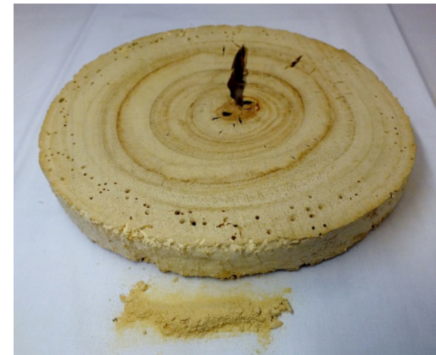
Figura 6.2. Orifícios de saída do besouro Lyctus e o pó fino associado ao ataque.
