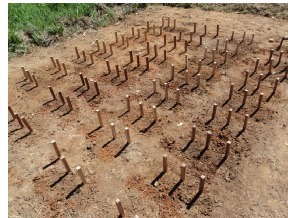
Figura 8.1. Detalhe de campo de apodrecimento em ambiente de campo aberto.
