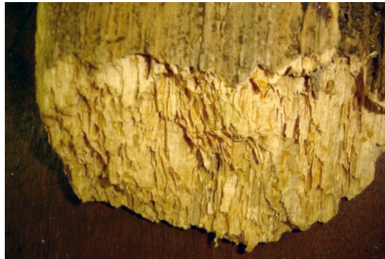
Figura 3.2. Madeira atacada por fungo de podridão mole.
