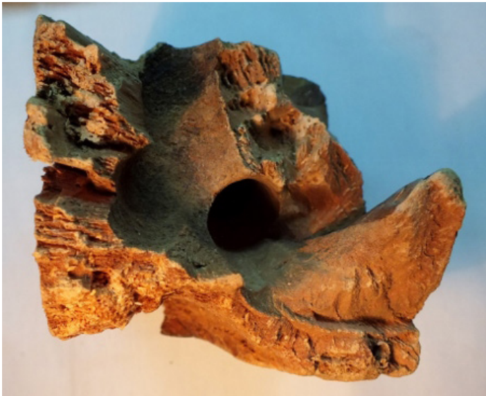
Figura 6.5. Orifícios na madeira deixados por uma abelha Mamagava.
