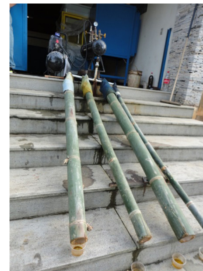
Figura 11.3. Processo Boucherie aplicado em bambu.
