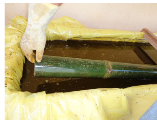
Figura 11.1. Processo de imersão prolongada do bambu Dendrocalamus giganteus em solução CCB.
