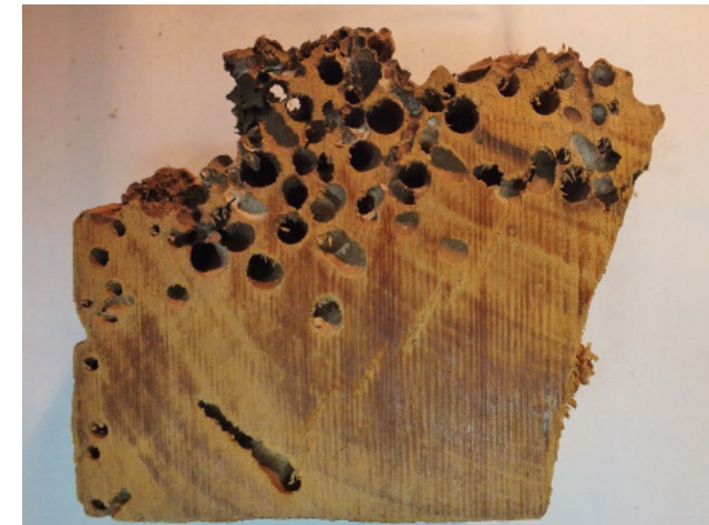
Figura 7.1. Amostra de madeira severamente atacada por Teredos Fonte: Autoria própria (2016)
