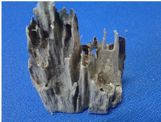
Figura 5.6. Exemplo de peça de madeira tropical severamente atacada por cupins.
