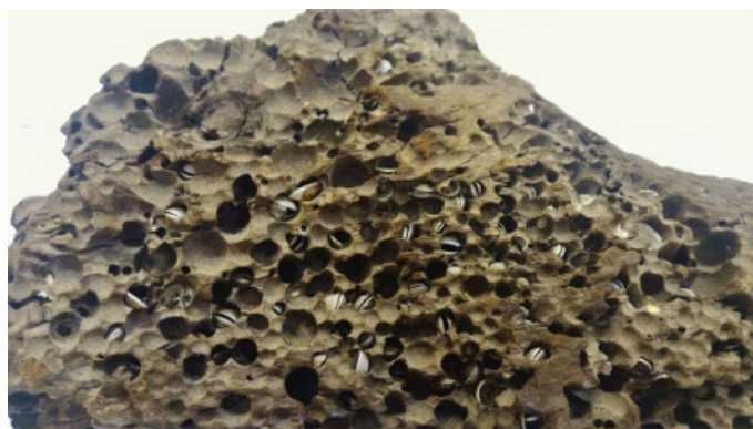
Figura 7.2. Madeira atacada por Martesia sp.
