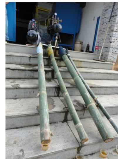
**Figura 11.3.** Processo Boucherie aplicado em bambu.
