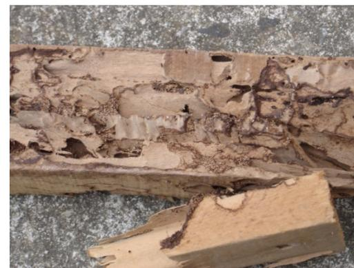
**Figura 5.3.** Amostra de madeira atacada por cupins subterrâneos.
