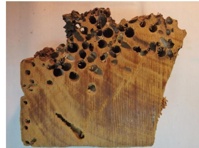
**Figura 7.1.** Amostra de madeira severamente atacada por Teredos
