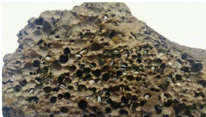
**Figura 7.2.** Madeira atacada por *Martesia* sp.
